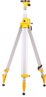
120-290cm çalışma yüksekliği, 300cm maksimum yükseklik. 5/8" tripod bağlantısı, 7.6kg ağırlık, Tripod ayakları kaymayı önleyen lastik muhafazalıdır aynı zamanda ayaklarda zincir bağlantısı bulunmaktadır. CM skalalı. Tüm Rugby, Roteo, NA300, ve Sprinter serisi cihazlar için.
