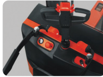
Akü Şarj göstergesi ve acil stop butonu.
