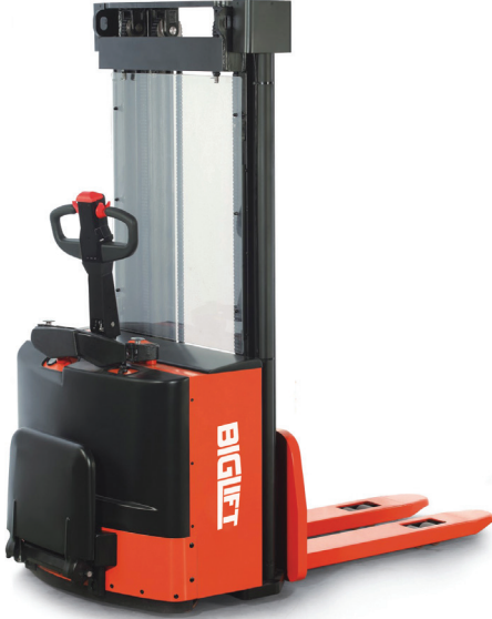
Akü Şarj göstergesi ve acil stop butonu.
